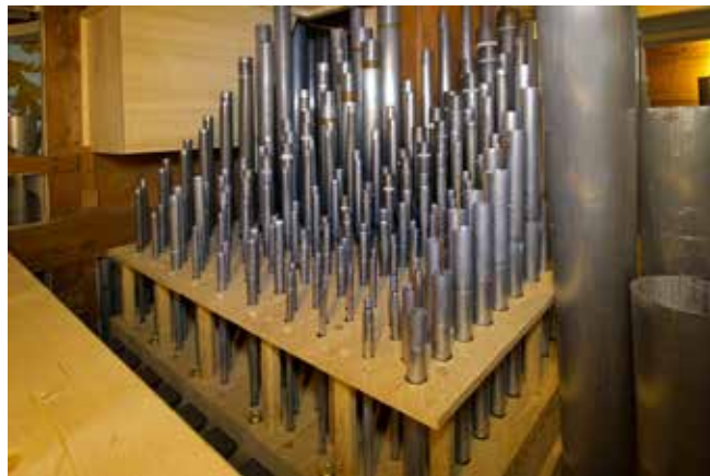
Pijpwerk van het bovenwerk. Links, met nieuw hout, de dakaanvulling die ter sprake kwam bij de detailfoto van de bovenste tussenvelden. Rechts bekers van de Trompet 8 vt van het hoofdwerk.
